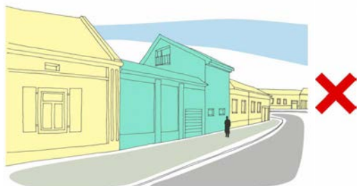
A garázsajtó és a kisméretű garázssablakok nem tudják helyettesíteni az utcai homlokzaton a kialakult nyílászáró-osztás megjelenését.
